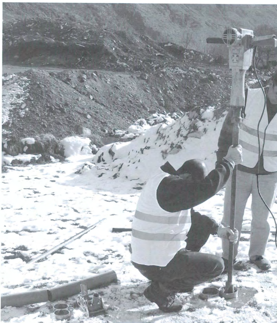
FIGURA 4. Sondeig de percussió a la torbera de València d'Aneu. FOTOGRAFIA: Ramon Pérez-Obiol.
